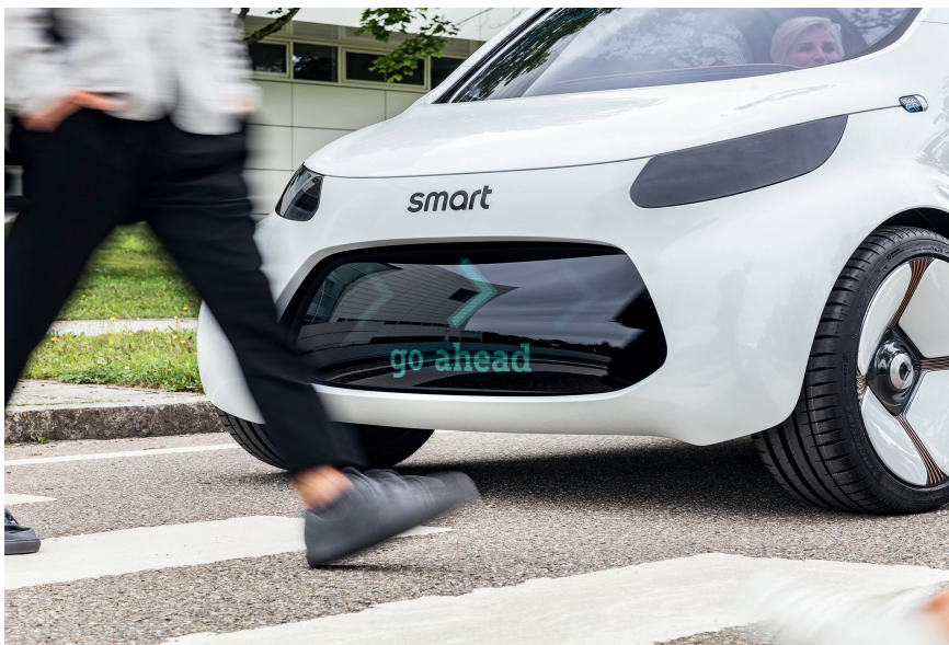
Kommunikativer Frontgrill: Geschlossen, dekoriert, beleuchtbar und durchlässig für Radar- und Lidar-Sensoren wie hier am autonomen Konzeptfahrzeug Smart Vision EQ © Daimler
